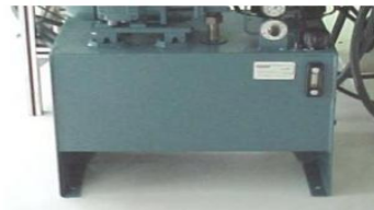
Reservatório de fluido hidráulico.
