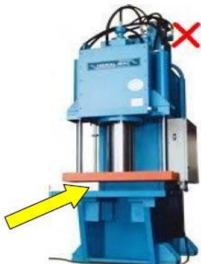
PH com zona de prensagem desprotegida.
